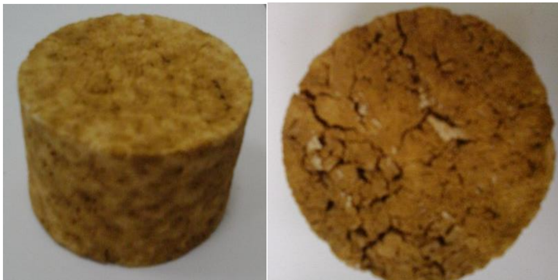
Рисунок 3. – Образец из глины Салмановского месторождения с добавкой 4% модификатора S при температуре обжига 1100 °C.
