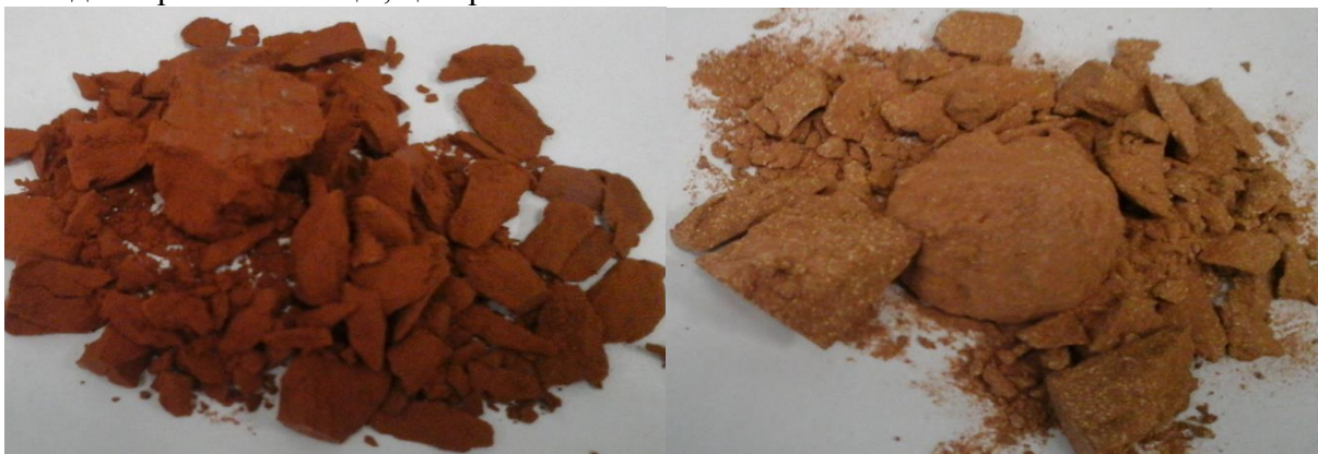
Рисунок 4. – Характер разрушения образца без добавки (слева) и образца с 20 % ЦСП Татарско-Шатрашанского месторождения (справа). T_{\text{обж.}} = 1100^{\circ}\text{C} .
