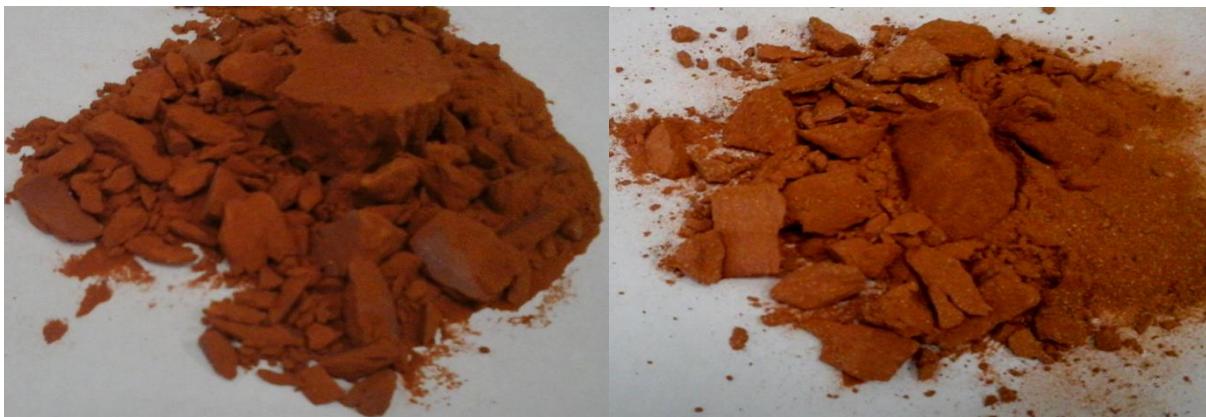
Рисунок 3. – Характер разрушения образца без добавки (слева) и образца с 15 % ЦСП Татарско-Шатрашанского месторождения (справа). T_{\text{обж.}} = 1000^{\circ}\text{C} .
