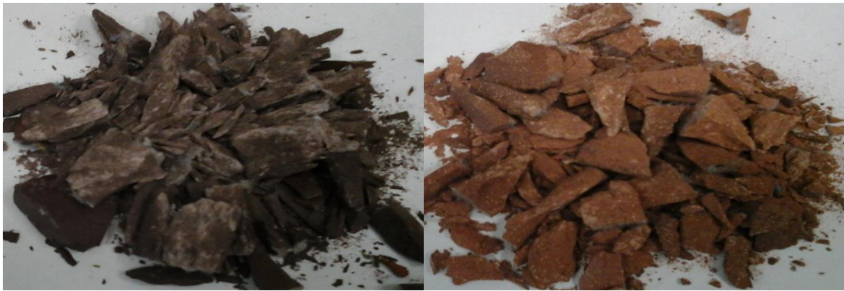
Рисунок 5. – Характер разрушения образца без добавки (слева) и образца с 15 % ЦСП Татарско-Шатрашанского месторождения (справа). T_{обж.} = 1150^{\circ}\text{C} .
