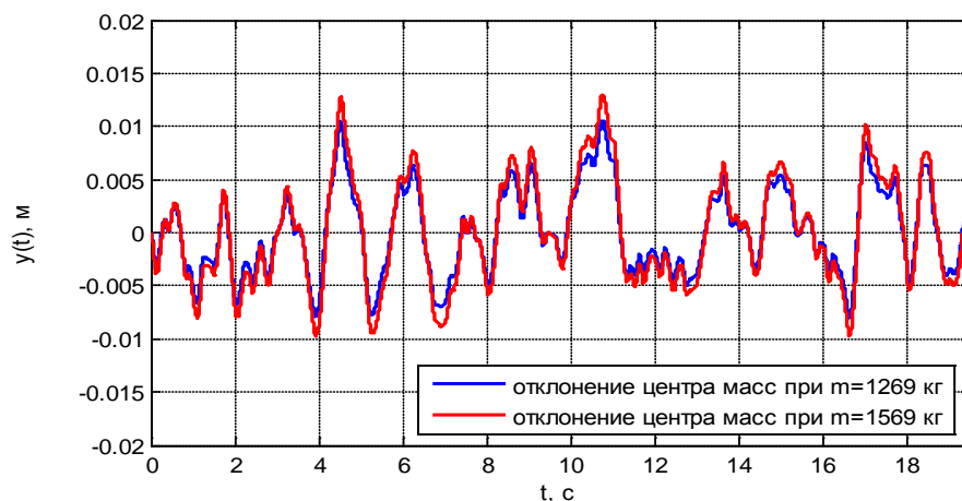
Рисунок 3. – Смещение центра масс нагруженного и ненагруженного автомобилей при нечётком управлении.
