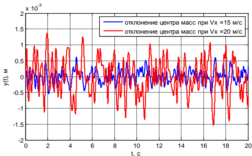
Рисунок 6. – Смещение центра масс автомобиля с субоптимальным УУ при движении с разными продольными скоростями.
