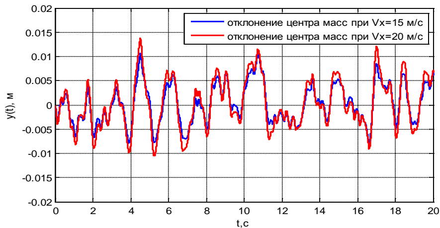
Рисунок 5. – Смещение центра масс автомобиля с нечётким УУ на разных скоростях.
