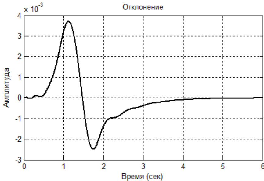
Рисунок 5. – Разница применения исходного и редуцированного на два порядка регуляторов.
