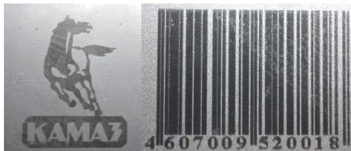
Рисунок 4. – Логотип нанесенной маркировки на деталь и штрих код, полученный с помощью ЛИ.
