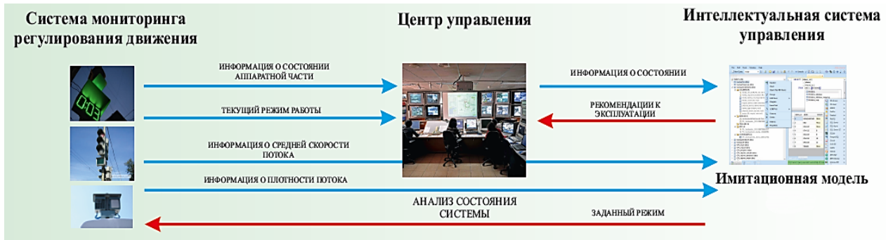
Рисунок 3. – Схема передачи данных в системе управления адаптивными светофорами.
