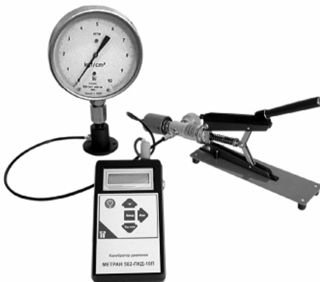
Рисунок 4. – Поверочный калибратор давления Метран-502-ПКД-10П.
